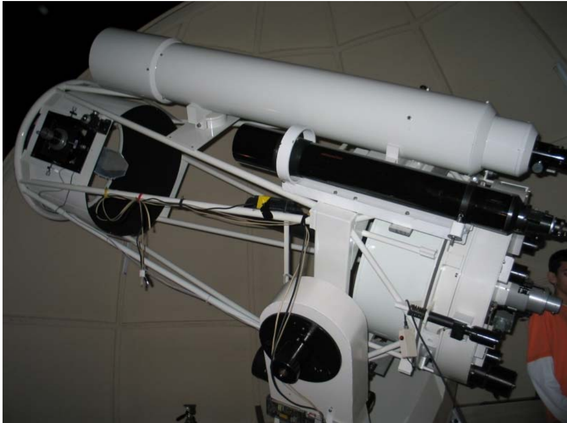
Foto: Telescopio T77, Newton-Cassegrain (doble foco)
